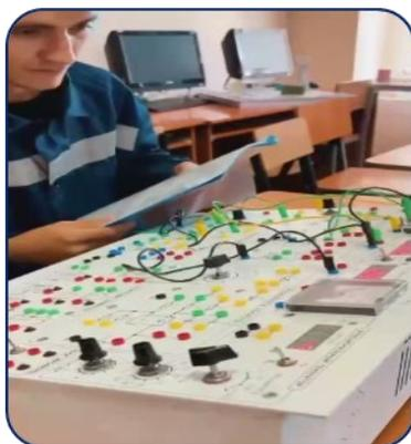
Лабораторный стенд обеспечивает проведение лабораторно-практических работ по разделам: «Линейные электрические цепи постоянного тока», «Линейные электрические цепи однофазного переменного тока», «Нелинейные электрические цепи постоянного и переменного тока», «Трёхфазные электрические цепи», «Полупроводниковые приборы», «Выпрямительные устройства», «Аналоговые электронные устройства», «Основы цифровой техники».
